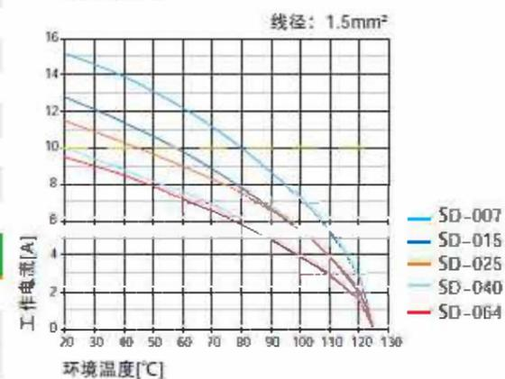
SD-007 Компактные вставки высокой плотности 250V 10A 7+⊥
