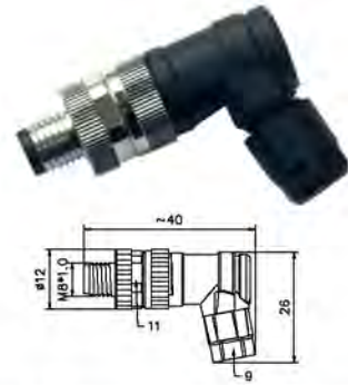
Штекерный угловой М8, в сборе (подключение на месте), незранированный, винтовой зажим
