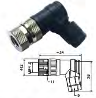
Штекерный угловой М8, в сборе (подключение на месте), незранированный, винтовой зажим
