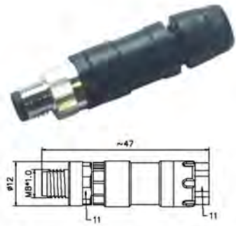
Штекерный прямой М8, в сборе (подключение на месте), незранированный, винтовой зажим
